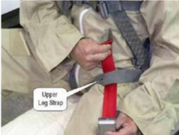
Figura 4. Pase el lazo de la correa debajo de la correa superior de la pierna
