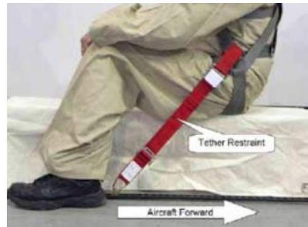
Figura 9. Fijación de sujeción de doble punto y doble atadura al piso para horquilla trasera
